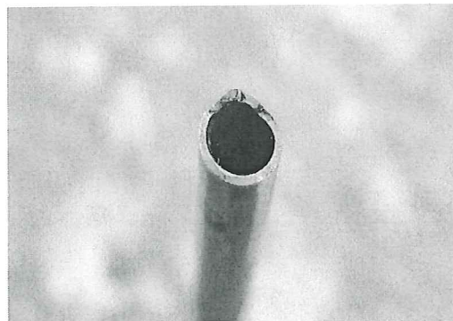
Fotografía No. 30 vista del área de la fractura de la tubería
